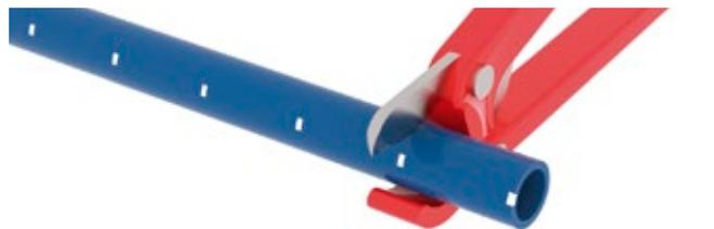
Труба обрезается ножницами перпендикулярно к оси трубы. Чтобы предотвратить сплющивание трубы следует трубу в ножницах повернуть.
