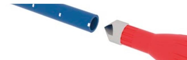
Внутренняя грань трубы слегка срезается ручным зенкером до глубины приблизительно 1 мм.
